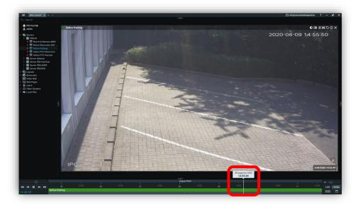
En déplaçant le marqueur avec la souris, vous pouvez vous déplacer rapidement en avant et en arrière dans les séquences enregistrées. Pour revenir au mode temps réel, faites glisser le marqueur vers la droite ou appuyez sur le bouton temps réel. Si la souris se trouve au-dessus de la barre de temps verte, vous pouvez effectuer un zoom avant/arrière sur la ligne en tournant la molette de la souris.
