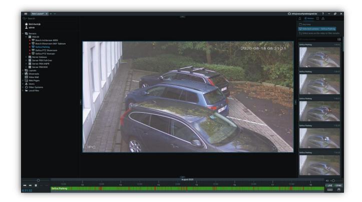
Sélectionnez maintenant avec la souris une partie de l'image vidéo sur laquelle vous souhaitez effectuer une recherche spécifique. Automatiquement, les morceaux rouges en bas de la ligne de temps seront adaptés uniquement à la partie sélectionnée de l'image vidéo. Les photos d'aperçu seront également ajustées à cette zone uniquement.
